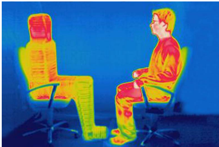
Bild A.4: Vergleich der Wärmeabgabe eines Personenlastsimulators mit einer Person.
