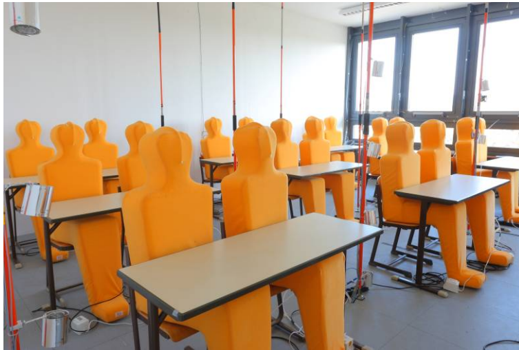
Bild A.3: Klassenraumansicht von innen mit Personenlastsimulatoren.
