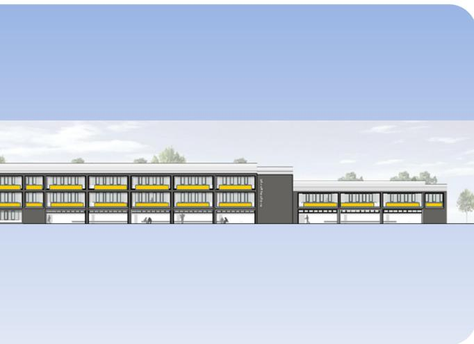
Die Uhlandschule in Stuttgart soll nach der Sanierung den Plusenergie-Standard aufweisen. Zum Sanierungskonzept gehören das Hauptgebäude und der Erweiterungsbau. Die noch auf dem Campus stehende Turnhalle und der Pavillonbau werden rückgebaut und durch Neubauten ersetzt. Das dreigeschossige Hauptgebäude ist als Seitenflurtyp ausgeführt - am Flur liegen also nur auf einer Seite Klassenräume.
