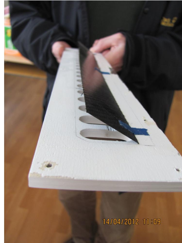
Neue Klappe aus glasfaserverstärktem Kunststoff
