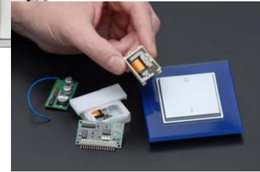
Funk-Schalter und -Raumtemperaturfühler Quelle: EnOcean
